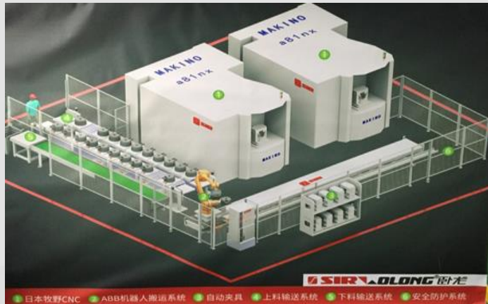
● 日本牧野CNC ● ABB机器人搬运系统 ● 自动夹具 ● 上料输送系统 ● 下料输送系统 ● 安全防护系统
